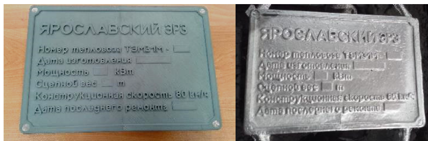
Рис. 1. Модель и алюминиевая отливка таблички тепловоза ТЭМ31М
