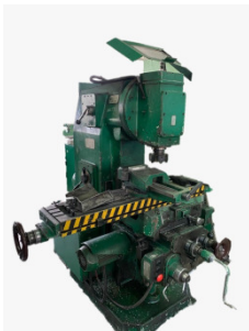
Рис. 3. Консольно - фрезерный вертикальный станок 6P11
