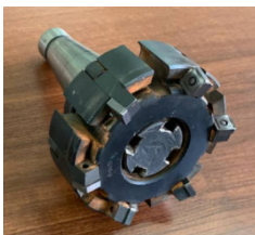
Рис. 4. Торцевая фреза со сменными пластинами
