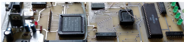
Рис. 1. Печатная плата контроллера электропривода
