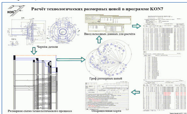
Рис. 1. Размерная структура варианта ТП
